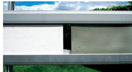
**Lanco® Ultra Siliconizer™** se mantiene reflectante y más blanco (lado izquierdo) que otro revestimiento elastomérico de acrílico o copolímero acrílico (lado derecho) aún después de 3 años de servicio en la superficie.
