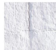
**Lanco® Urethanizer™** demuestra superioridad como sellador de techos con movimiento y grietas, en comparación con otros revestimientos elastoméricos. Después de dos meses de aplicado, **Lanco® Urethanizer™** (parte inferior) se mantuvo intacto después de un año de exposición a temperaturas que van desde -15 °F a 100 °F, mientras el otro revestimiento aplicado falló completamente (parte superior).
